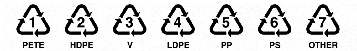
Figura 5. 1)PET o PETE 2) HDPE (Polietileno de alta densidad) 3) PVC (Cloruro de polivinilo) 4) LDPE (Polietileno de baja densidad) 5) PP (Polipropileno) 6) PS (Poliestireno) 7) Otros.
