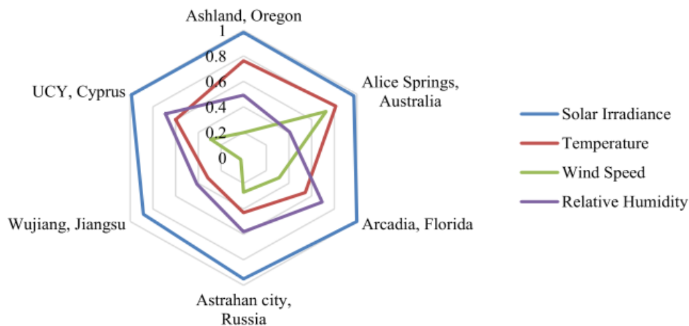
Figura 2.4. Correlación entre las variables meteorológicas y la potencia PV generada en distintas ubicaciones geográficas [30].
