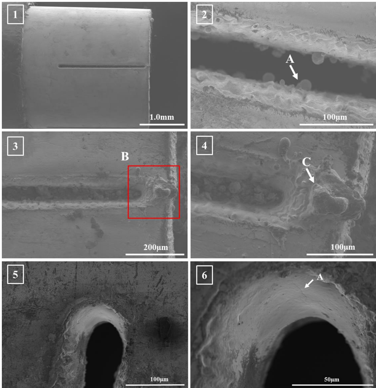
Figura 29. Muestra procesada con v=15\text{mm/s} , f=200\text{kHz} y \tau=60\text{ns} .
