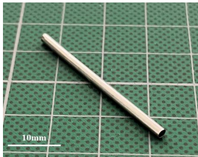
Figura 25. Segmento de tubo de CoCr L605.
