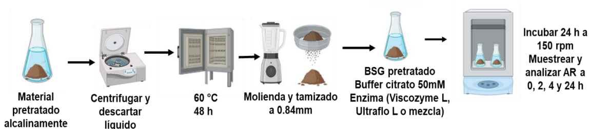
Figura 8. Diagrama de la metodología empleada para la hidrólisis enzimática del BSG.
