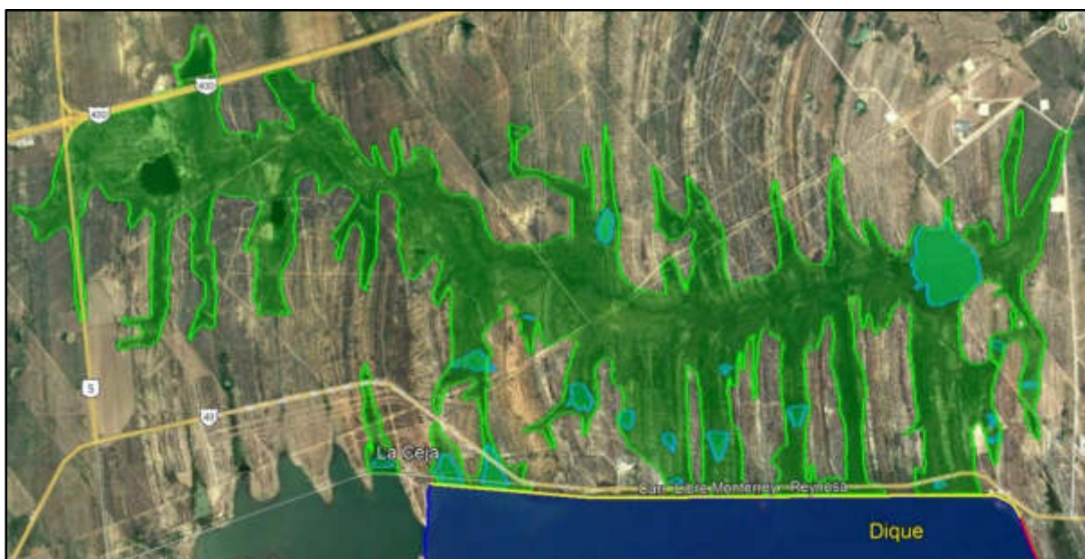
Figura 53. Delimitación espacial de las áreas afectadas, en zona aguas abajo del dique (elaboración propia a partir de imagen satelital de Google Earth Pro, 2021).
