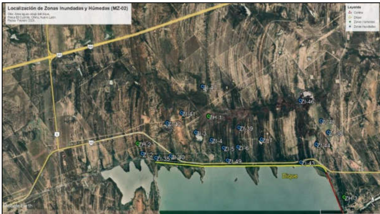
Figura 51. Localización de zonas con saturación hídrica (ZH) y zonas de humedales (ZI), en zona aguas abajo del dique (elaboración propia a partir de imagen satelital de Google Earth Pro, 2021).
