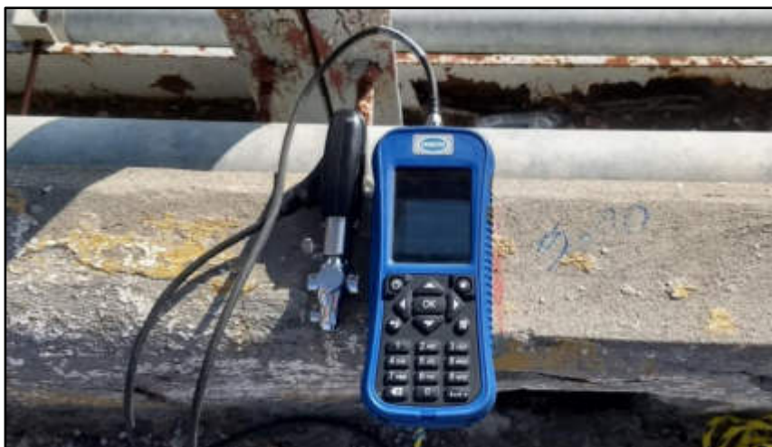
Figura 68. Medidor electromagnético de velocidad HACH-FH950 (elaboración propia, 2021).
