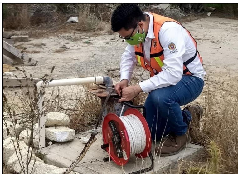
Figura 54. Identificación y medición del Pozo 1 (PZ-1) (elaboración propia, 2021).
