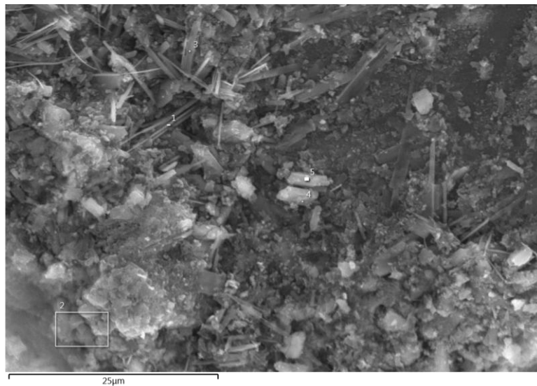
Figura 59 Área analizada por EDS del sistema 30 % AH a 28 días de curado, después de 40 ciclos de humectación y secado.
