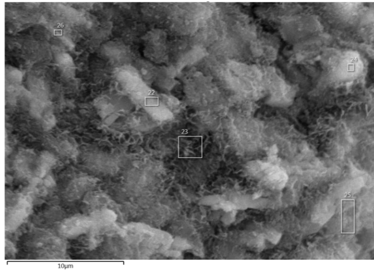
Figura 77 Área analizada por EDS del sistema 30 % AH a 28 días de curado, después de 400 °C.
