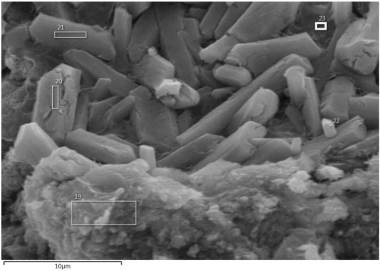
Figura 80 Área analizada por EDS del sistema 70 % AH a 28 días de curado, después de 400 °C.
