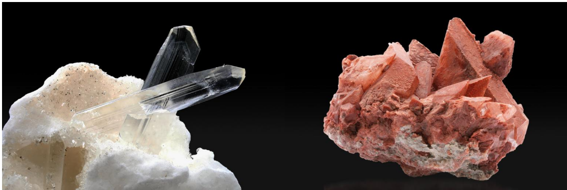
Figura 2 Yeso mineral de distintas tonalidades, el color blanco e incoloro denota la alta pureza del material, las tonalidades rojas indican impurezas de arcillas [40].
