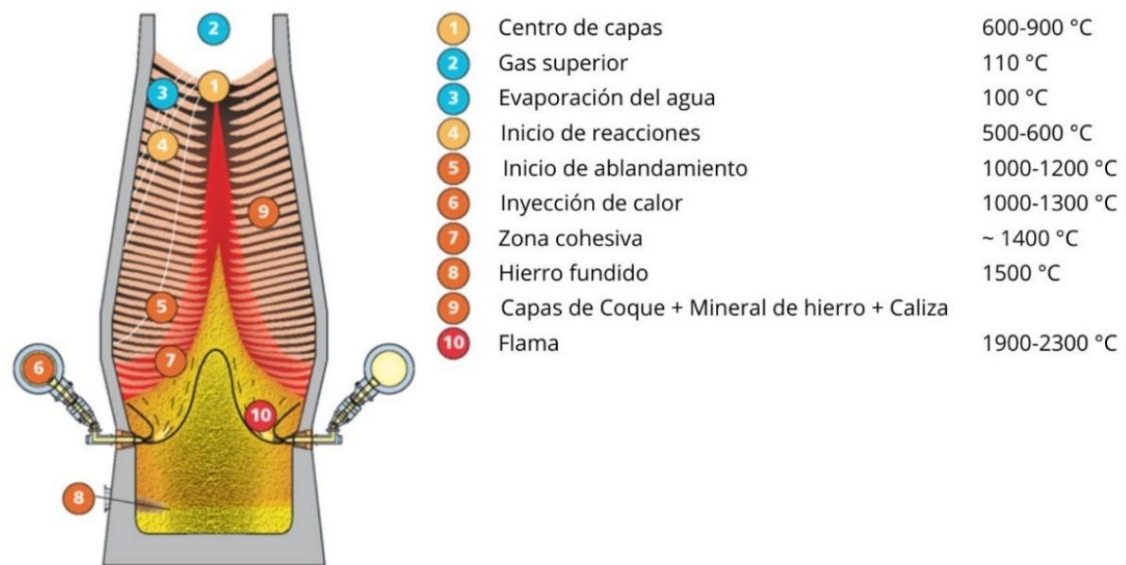
Figura 6 Proceso de obtención de EAH en un alto horno [55].
