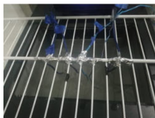
a) Colocación de termopares para proceso de calibración
