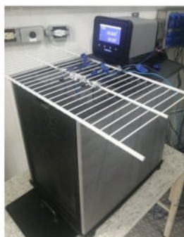
b) Calibración de termopares en baño térmico.
