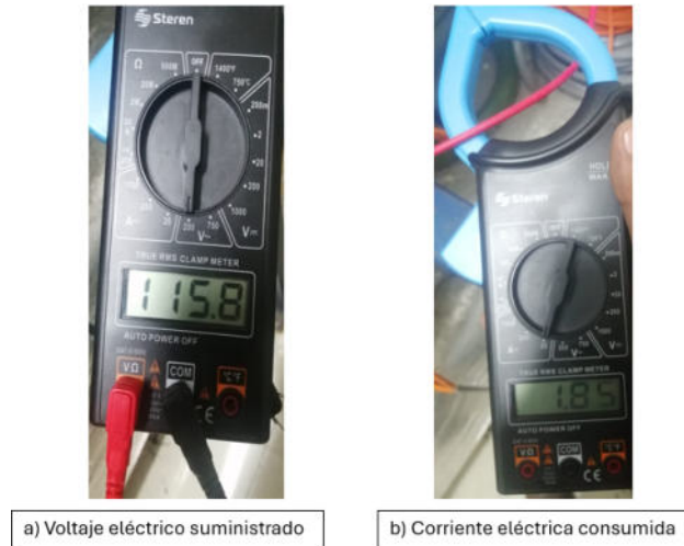
FIGURA 3.19: Lectura de voltaje y corriente eléctrica a través del amperímetro de gancho.
