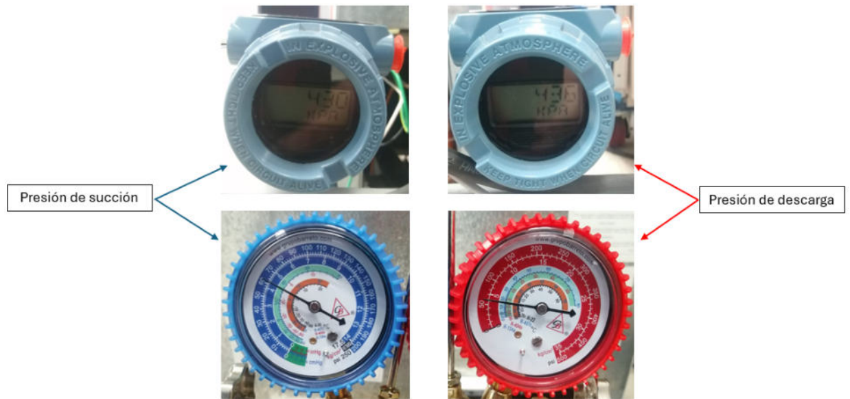
FIGURA 3.17: Comparación entre los sensores de presión y juego de manómetros
