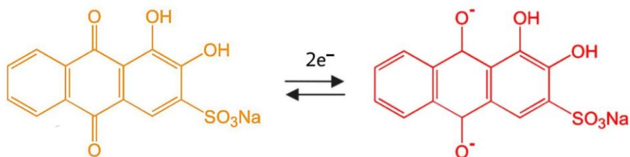
Figura 20. Cambio electroquímico que experimenta la molécula de ARS [50].
