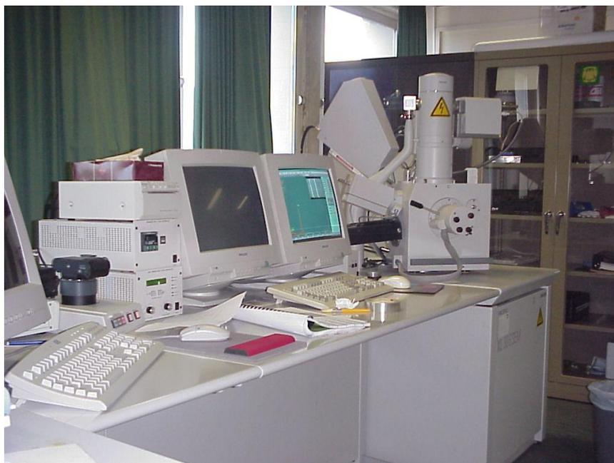
**Figura 4.2.** Microscopio electrónico de barrido ambiental equipado con OIM
