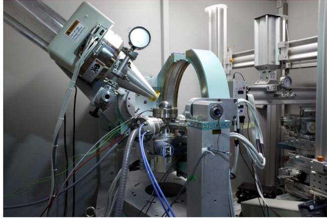
Figura 4.5. Difractómetro de rayos-X.
