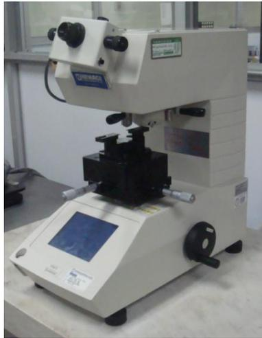
**Figura 3.1** Microdurómetro Vickers Shimadzu
