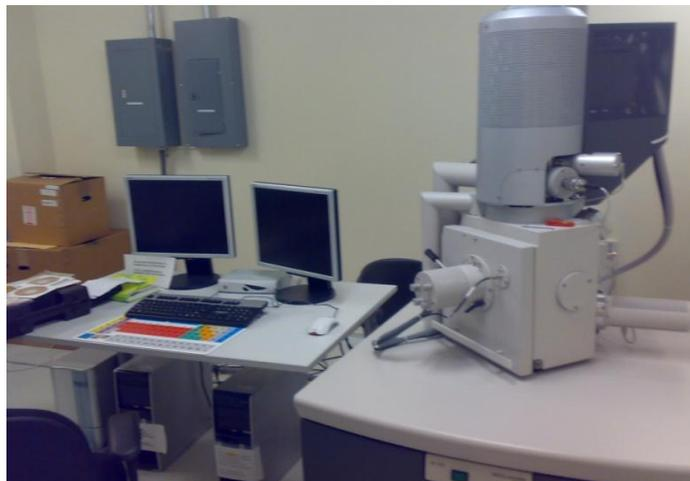
**Figura 3.9** Equipo de MEB utilizado.
