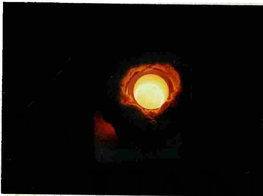
Figura 17. Fotografía donde se muestra la mezcla de reactivos dentro del crisol después de haber sido calentada durante 40 minutos en el horno de microondas.
