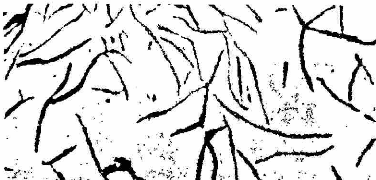
Fig. 9-1 Microestructura de una fundición gris ordinaria en bruto de colada. La probeta está pulida y sin atacar. El grafito aparece en forma laminar
