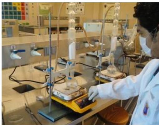
Figura 10. Extracción de aceites de *Jatropha curcas* L. por medio del equipo Soxhlet
