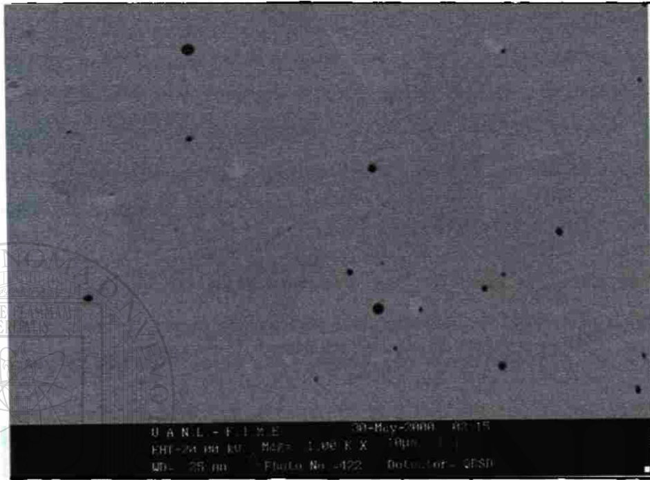
Figura 7.27 1000x muestra 6 (Poros debido a gas)
