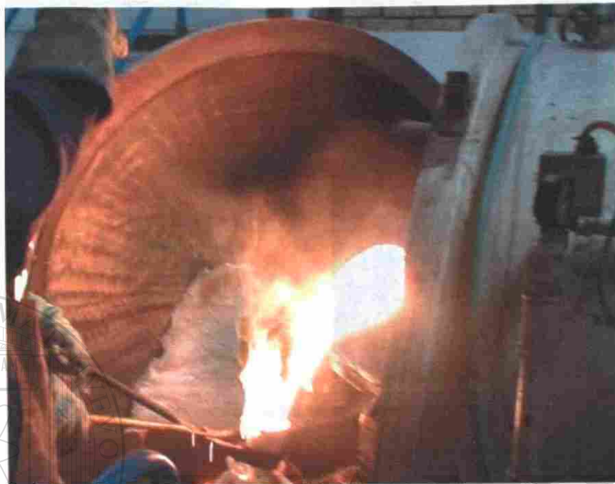
Figura 6.3 Vaciado de metal líquido.
