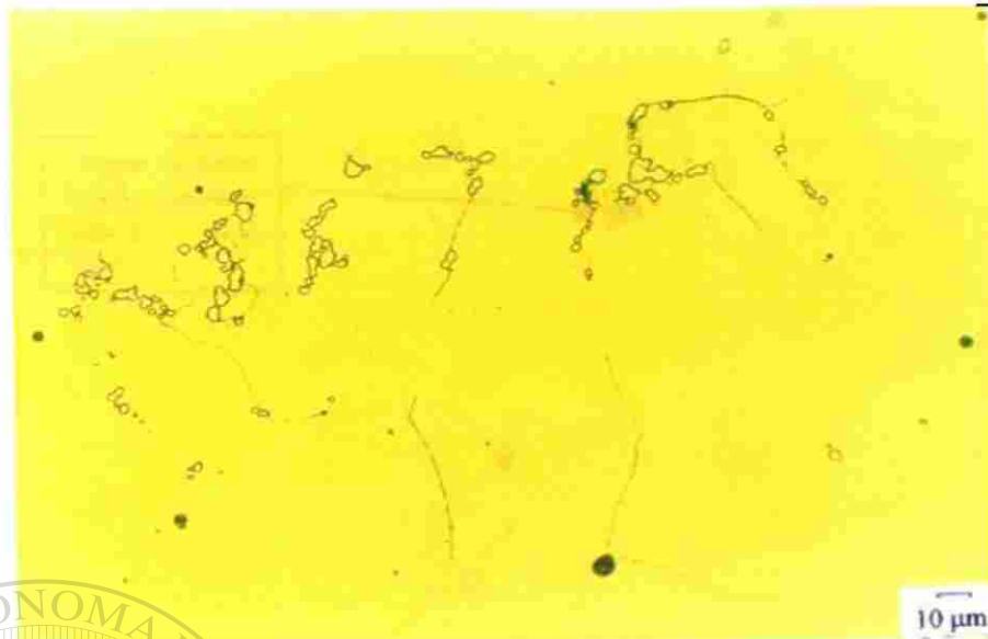
Fig. 7.12, muestra 7 (400x) Ataque electrolítico con ácido crómico velocidad de calentamiento: 130 °C/min. Se puede observar partículas con morfología globular (carburos M_6C ) ubicados en el límite de grano. Estas partículas miden entre 3 y 10μm.
