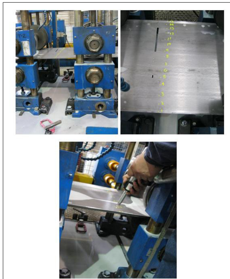
Figura 5.33 Medidas de puntos en la lámina entre la estación de rolado 1 y 2.
