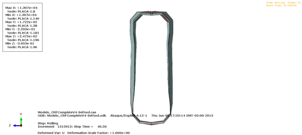
Figura 6.15. Geometría obtenida de la malla de 12x70 elementos.
