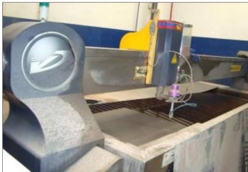
Figura 5.4 Máquina por chorro de agua utilizada para corte de probetas de tensión.
