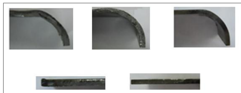
Figura 5.8 Corte de secciones de las muestras de medición de dureza.
