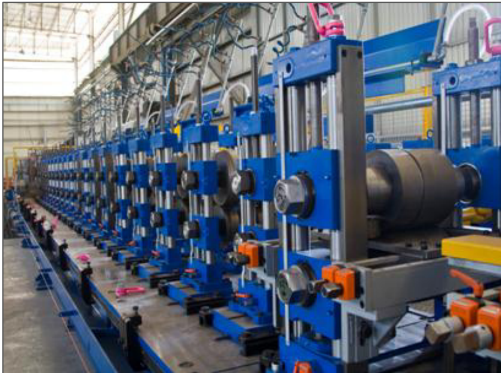
Figura 5.14 Línea de laminación no plana.
