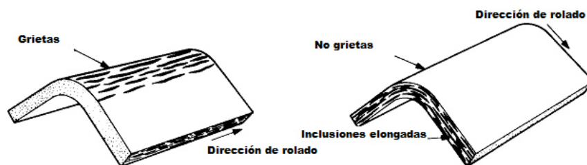
Figura 3.22 Efectos de orientación en el doblado de chapa metálica [5]
