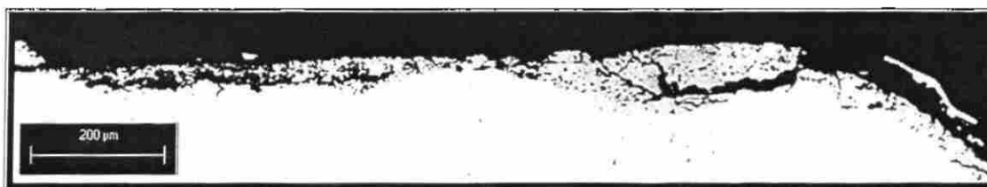
Figura 5.28. – Micrografía de sección transversal del electrodo que muestra adherencia sobre la cara del electrodo.
