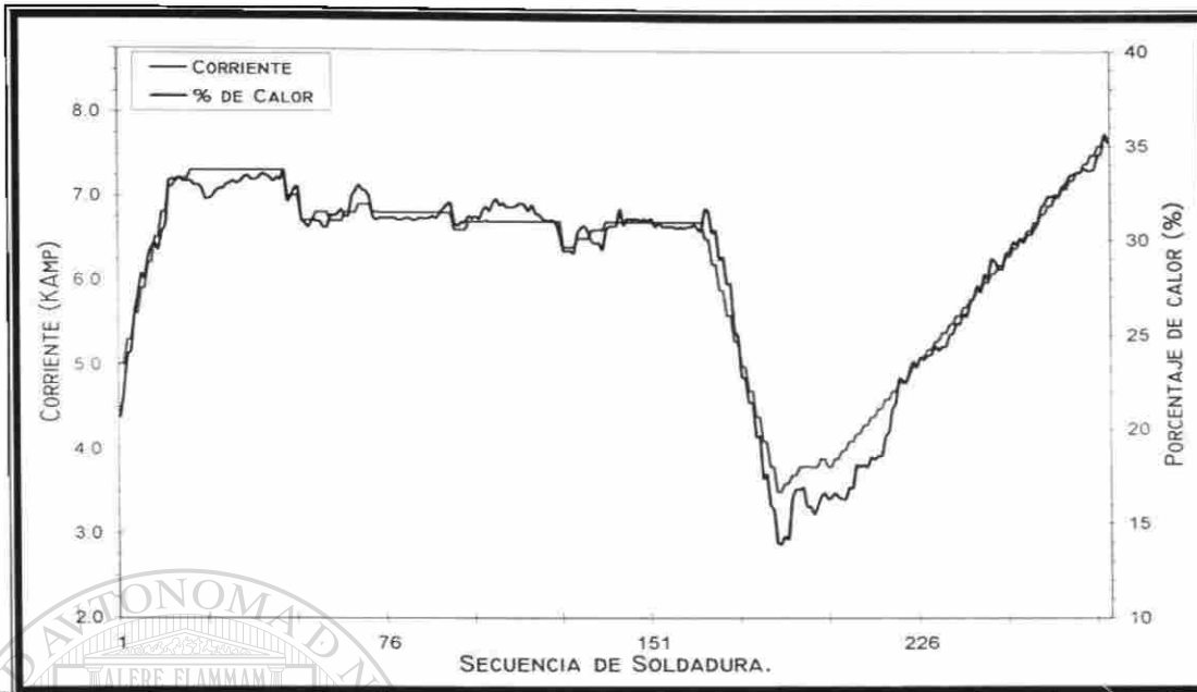
Figura 5.48. – Evolución de la corriente de soldadura y del calor durante la estabilización y la determinación de las corrientes iniciales de la prueba de resistencia de los electrodos.
