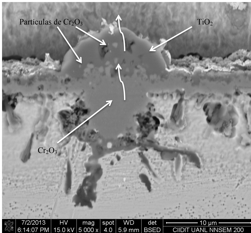
Figura 4. 48 Sección transversal de una muestra oxidada bajo condiciones CSVA durante 10 ciclos. Posible evidencia de la volatilización de cromo.
