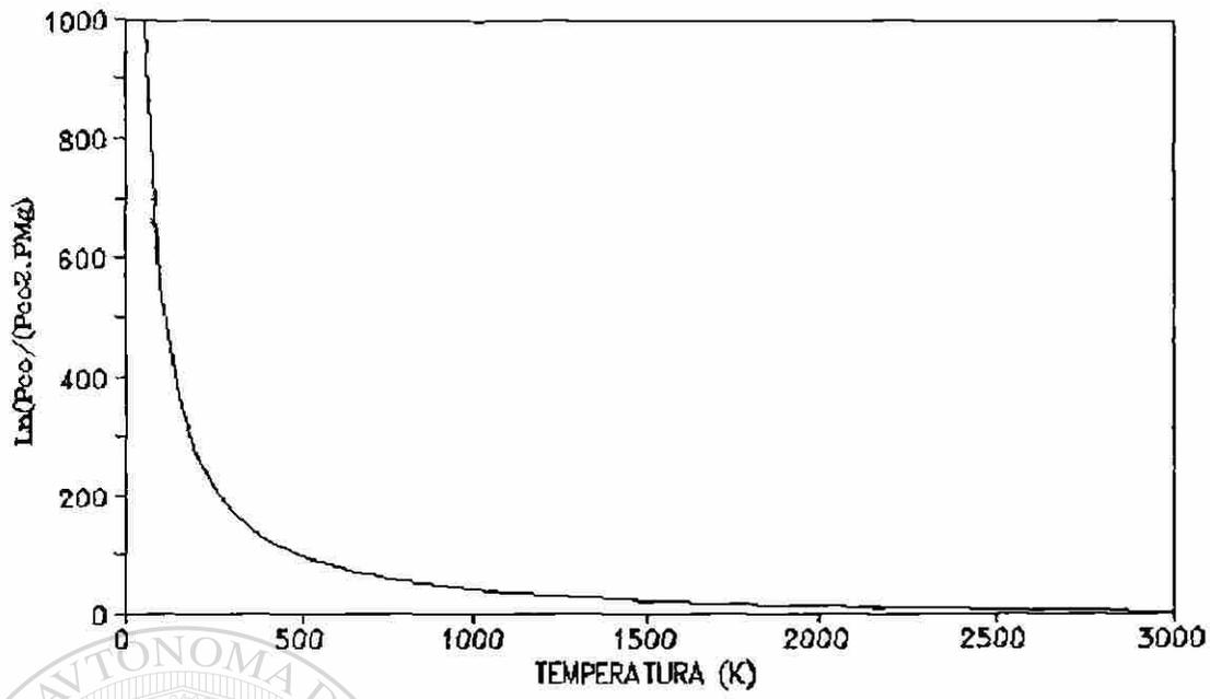
fig.16 Presiones parciales de CO, CO<sub>2</sub> y Mg en función de la temperatura para la reacción (12).
