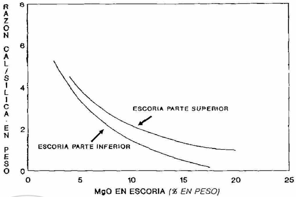
fig.2 MgO disuelto en escoria en función de la razón CaO/SiO<sub>2</sub>.
