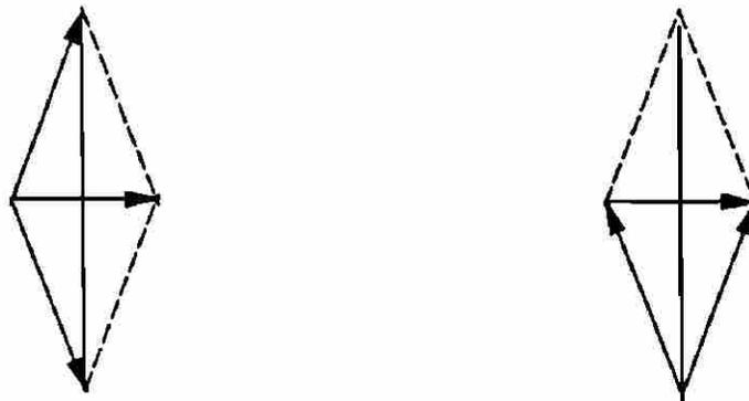
Figura 8.7 Diagramas fasoriales de cortocircuitos externos (a) e internos (b)
