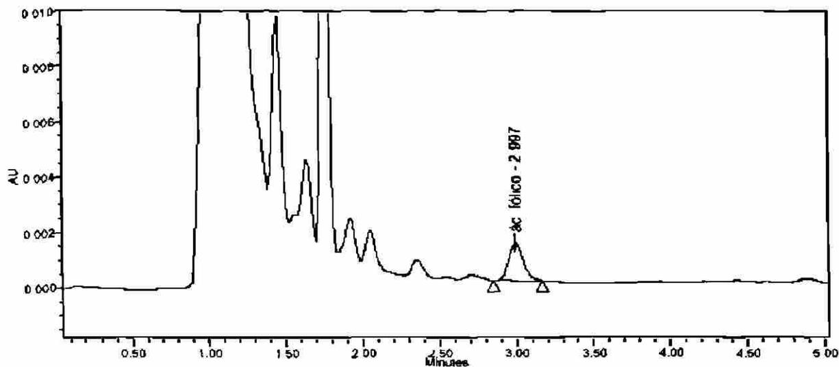
Figura 16. Cromatograma de una muestra de cereal de corn flakes de Kellog's lote B1. Pico cromatográfico correspondiente al ácido fólico con un tiempo de retención de 2.997 min.
