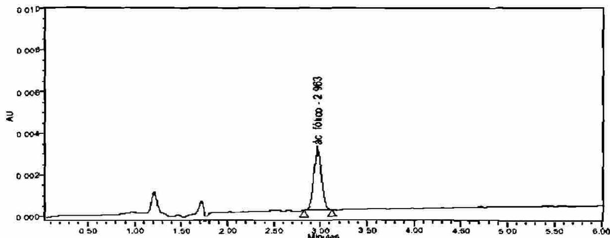
Figura 5. Cromatograma del estándar de ácido fólico de 1 ppm. Fase móvil ácido trifluoroacético 0.1% : acetonitrilo (85:15), fase estacionaria columna de fase inversa Atlantis dC18 5 $\mu$ m de diámetro de partícula 4.6 x 150 mm., flujo 1.4 mL/minuto y detección a 280 nm.
