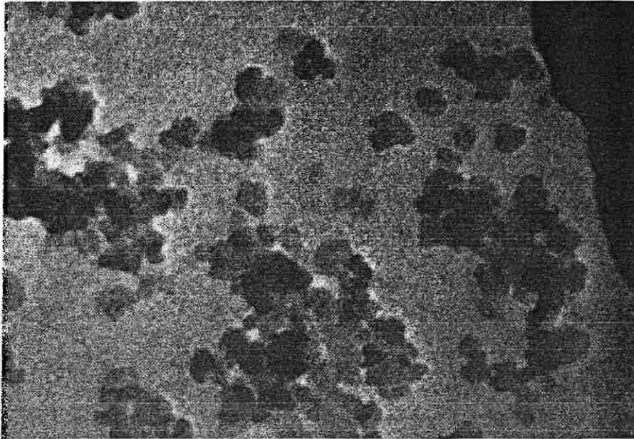
**Figura 23. - Imagen de MET que muestra las partículas constituyentes del pigmento AM2 a 80,000 X. A la izquierda se aprecia un aglomerado en el cual con mayor amplificación se pueden identificar partículas individuales.**
