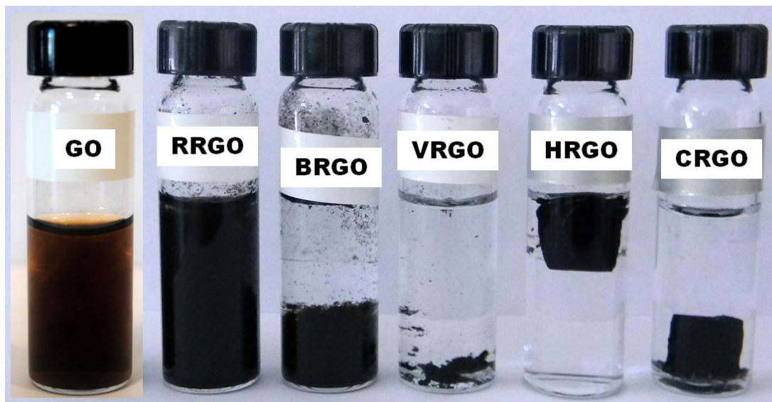
Figura 25. Dispersión en medio acuoso del óxido de grafeno antes y después de la reacción de reducción, utilizando diferentes agentes reductores químicos.
