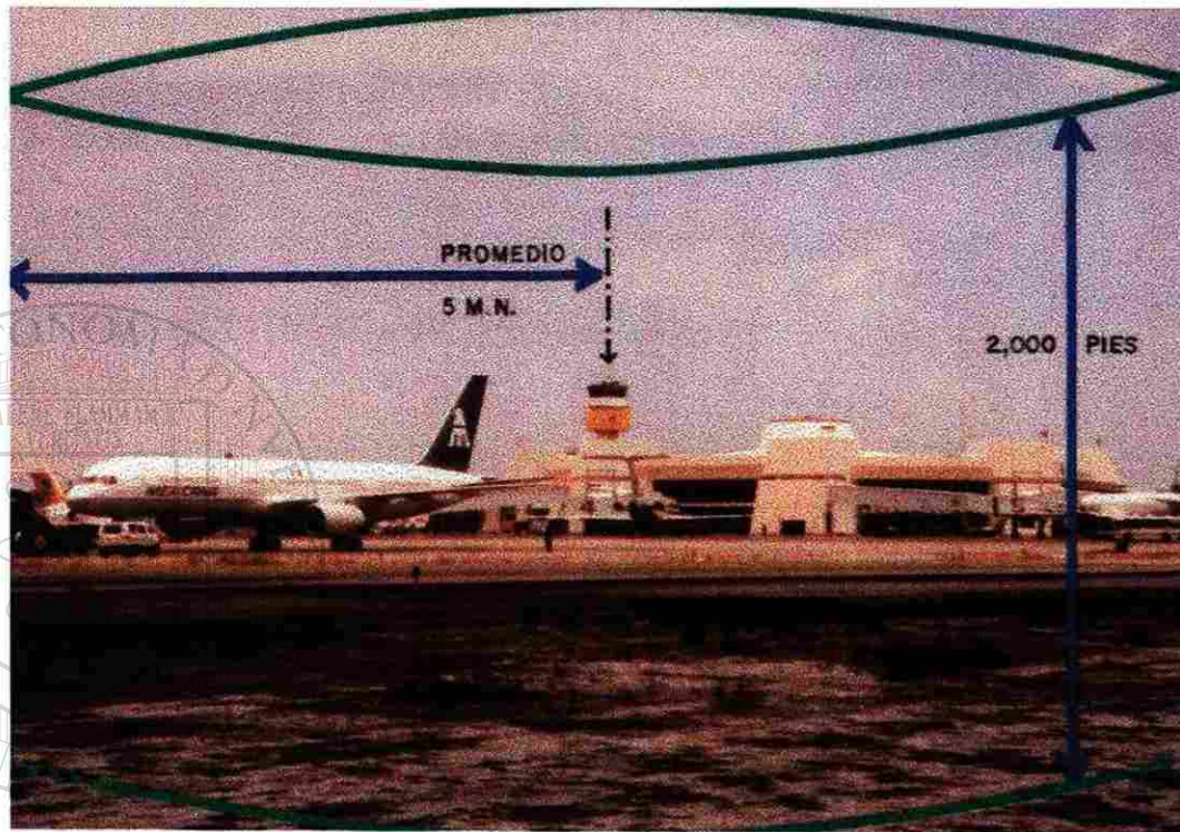
Fig.9.2 Área de control de aeródromo
