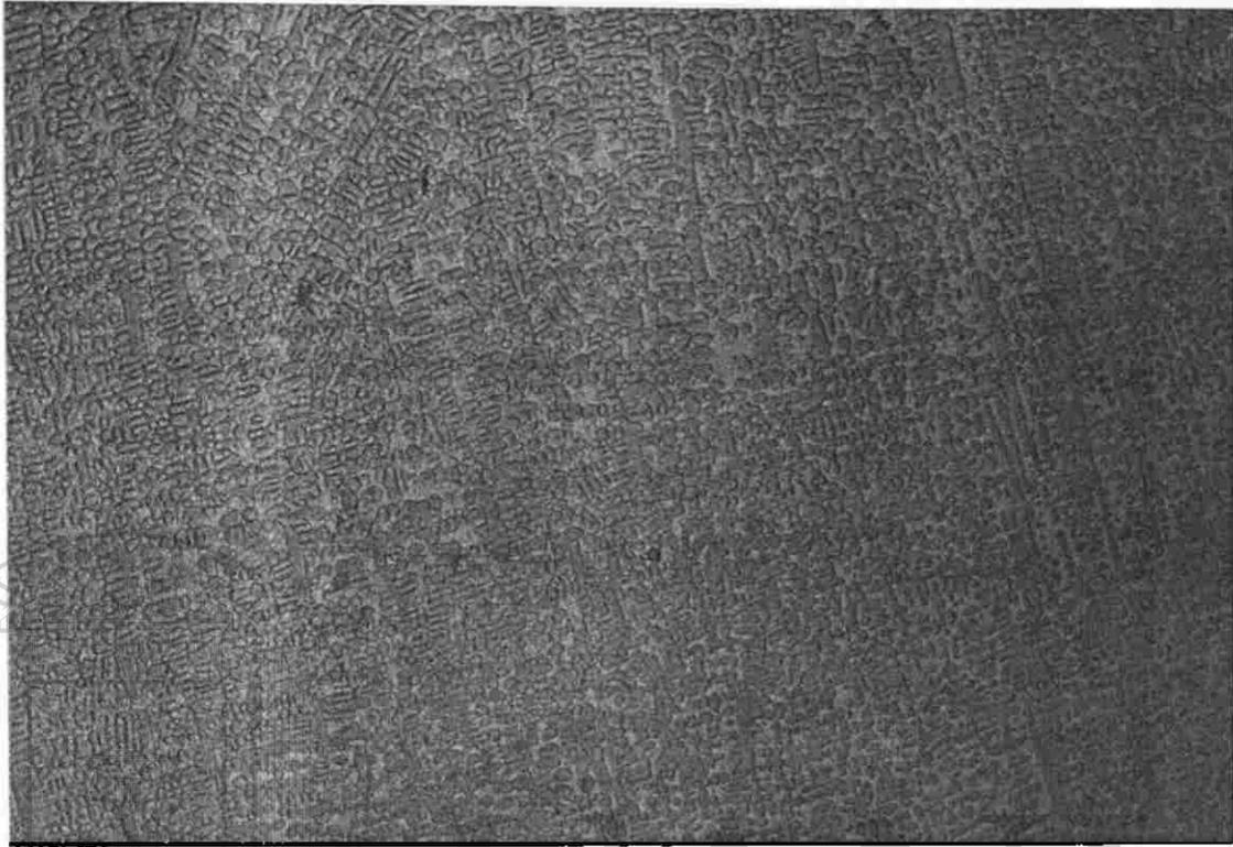
Figura 3.3 Microestructura del recubrimiento tipo Stellite 6.
