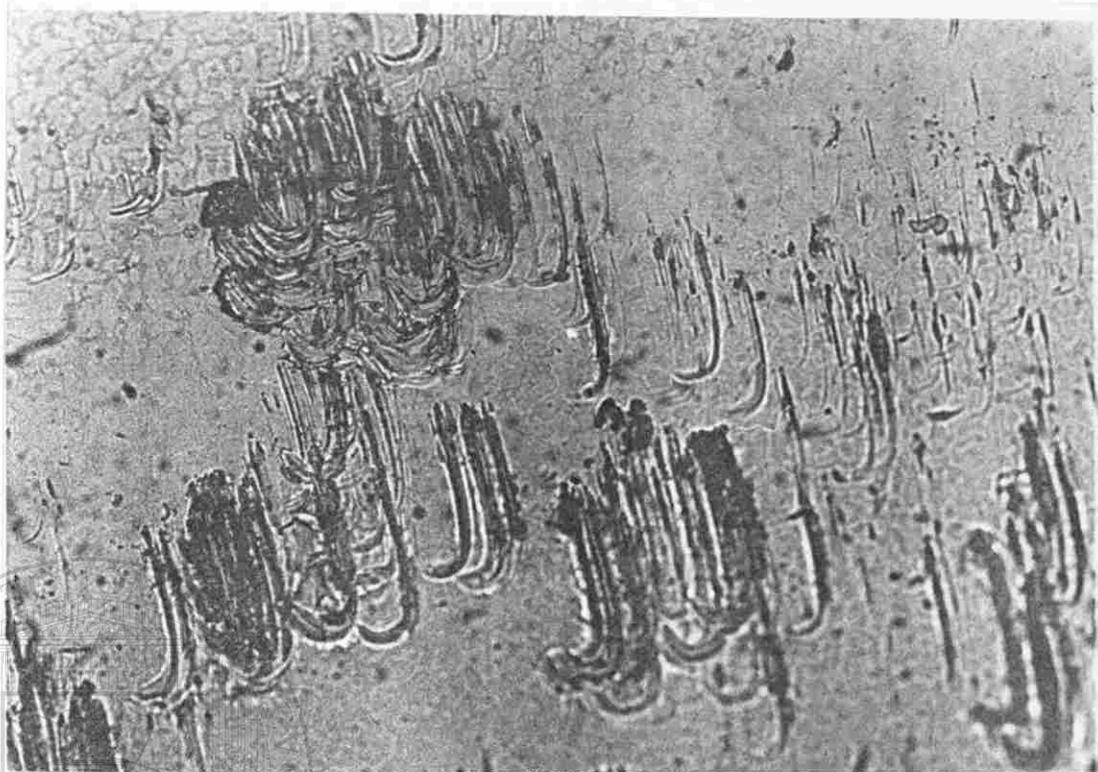
Figura 4.1 Recubrimiento tipo Stellite 6 después de impactado en la que se observan las deformaciones dejadas por los impactos de hierro esponja.
