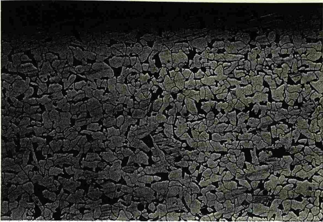
Figura 5.1 Microestructura del acero ASTM A106 B a 200 X. Atacada con Nital 2%.
