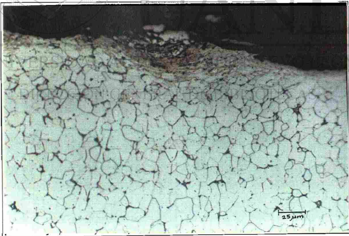
Figura 6.8. AISI 1005 zona inferior desgastada a 400X.
