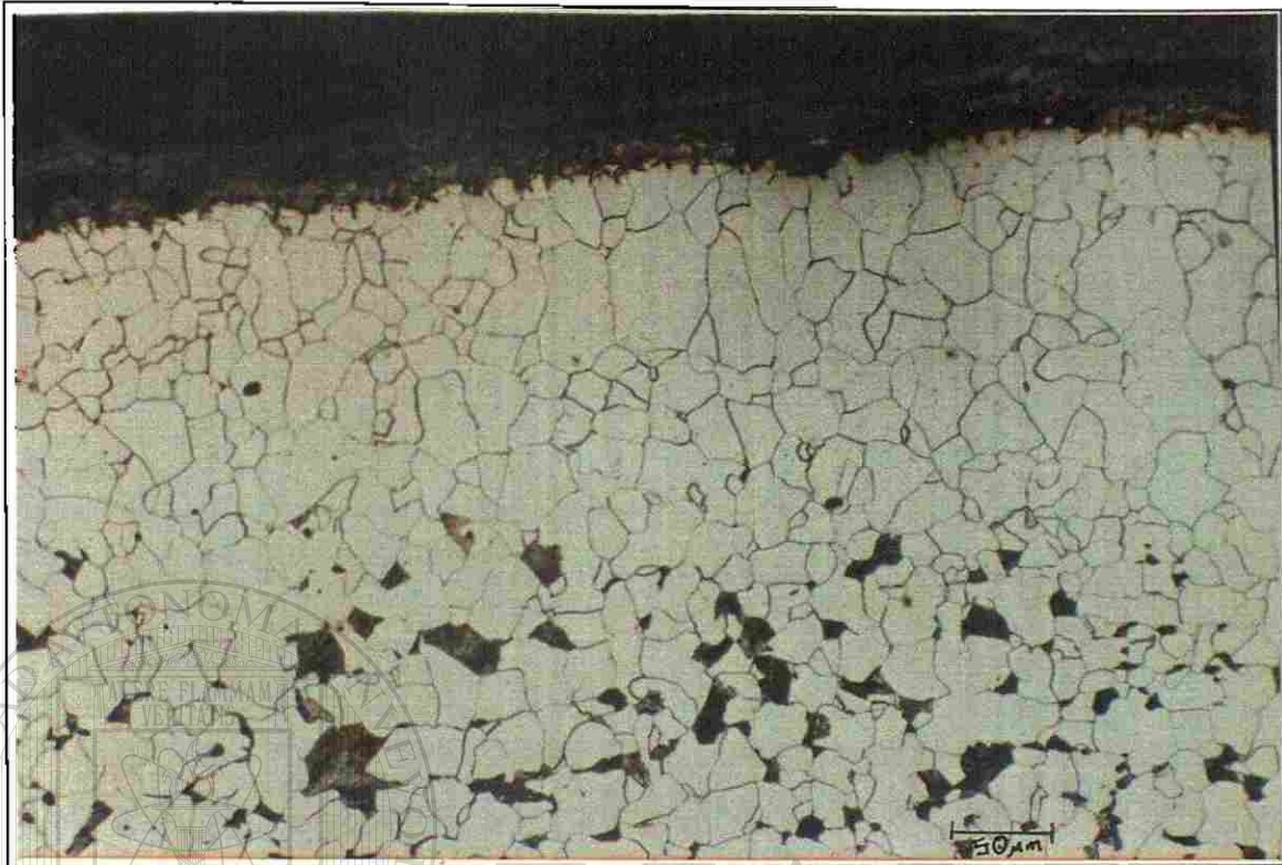
Figura 6.15. Microestructura del P-11 sin desgastar, zona inferior a 200X.
