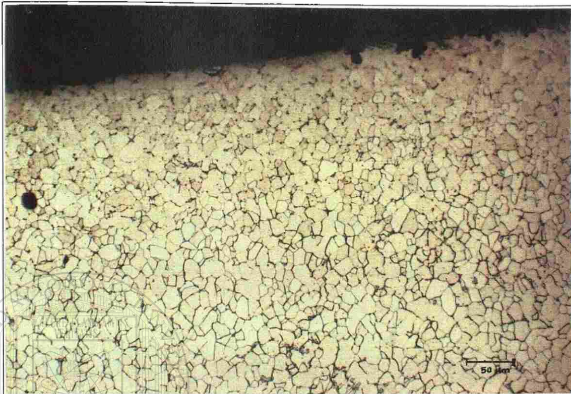
Figura 6.5. Microestructura del AISI 1005 sin desgastar, zona inferior a 200X
