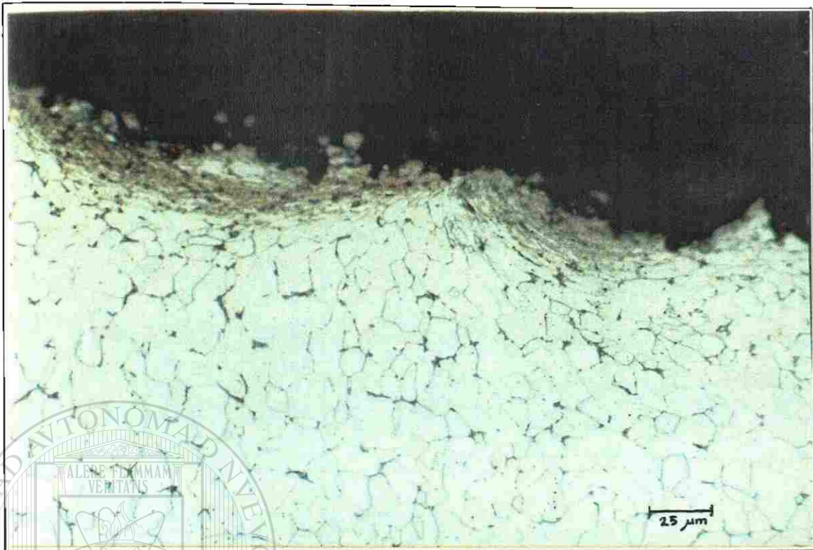
Figura 6.7. AISI 1005 zona inferior desgastada a 400X
