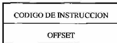
Fig 3.13 Estructura de una instrucción del modo indexado
