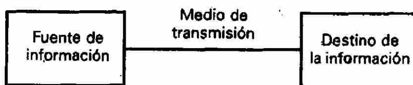
Figura 5-1 Diagrama a bloques simplificado para un sistema de comunicación electrónica.
