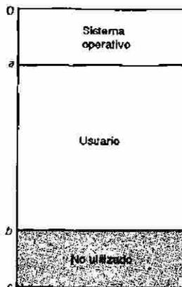
Fig. 4.3. Protección de los sistemas de usuario único
