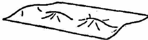
Figura 1.1.- Esquema del defecto de ondulaciones al centro y a las orillas.
