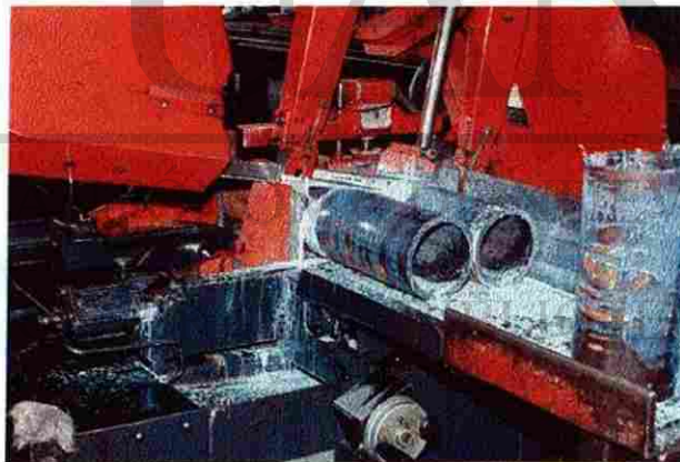
Figura 2.2 Etapa de corte de tubería.
