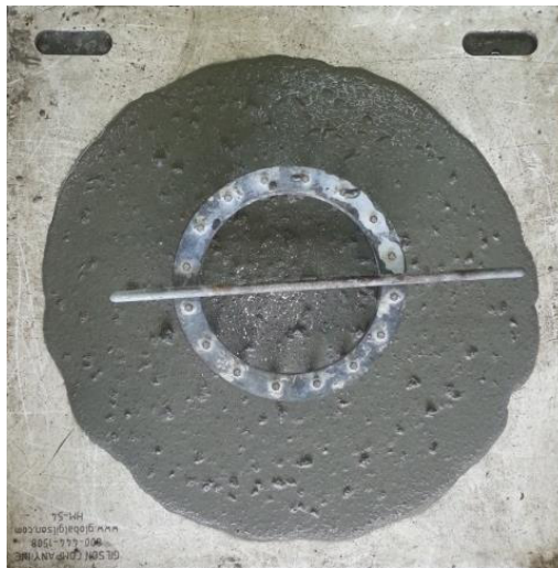
Figura 62. Prueba de Anillo J ejecutada en una muestra no homogénea de la mezcla +6WR.
