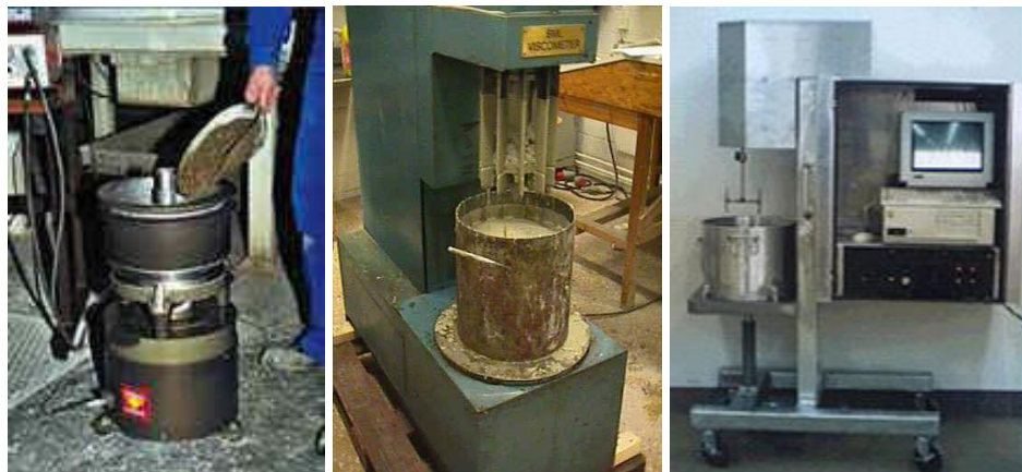
Figura 3. Reómetros para concreto. De izquierda a derecha, BTRHEOM (placas paralelas), ConTec BML Viscometer (coaxial) e IBB Rheometer (paleta).
