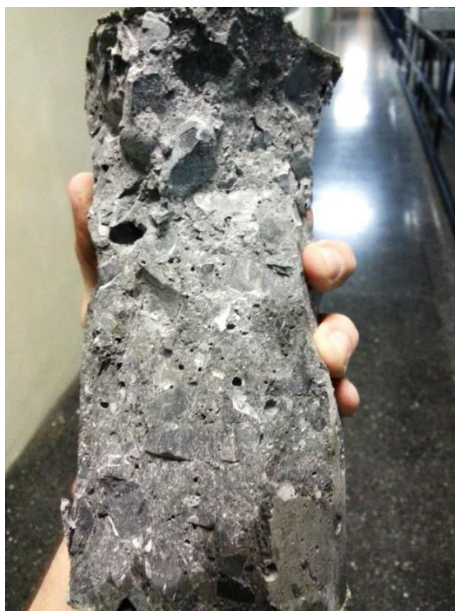
Figura 99. Aire atrapado en un espécimen para determinación de resistencia a la compresión de la mezcla -6WR.
