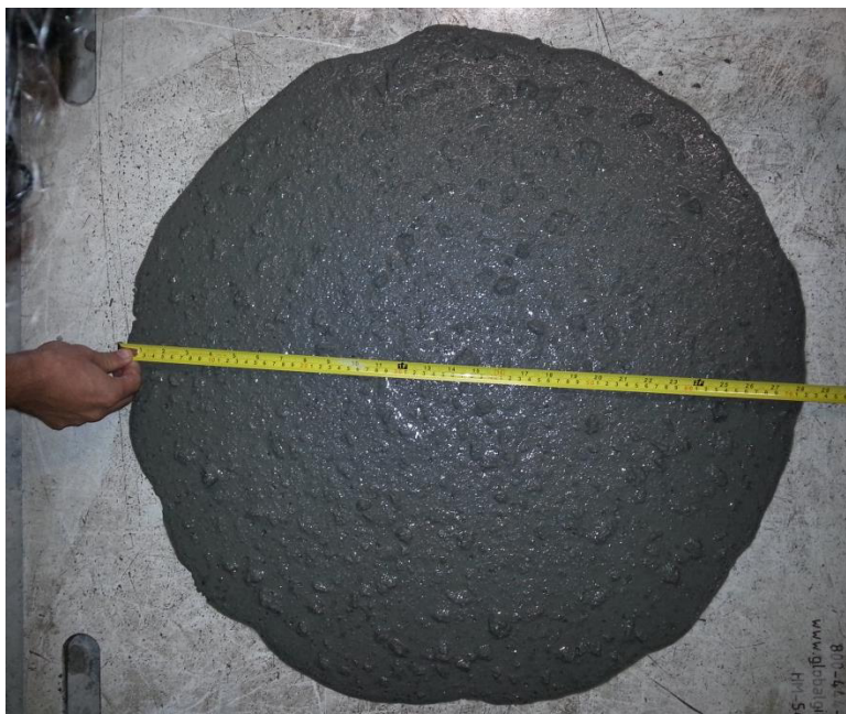
Figura 27. Flujo de revenimiento
