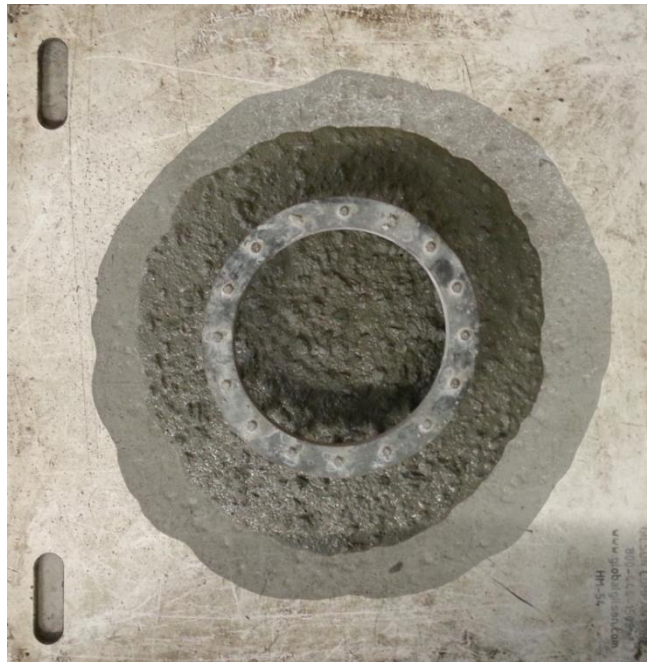
Figura 51. Diferencia entre el diámetro del flujo de revenimiento con y sin anillo J del CAC.
