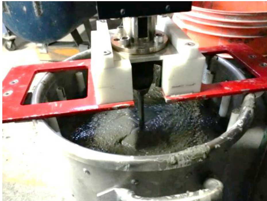
Figura 28. Contenedor llenado parcialmente para suprimir el torque generado en la cara superior del cilindro interior.
