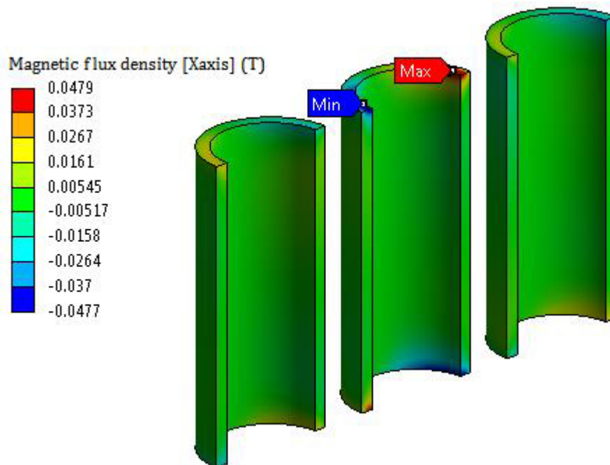
Figura 71. Contornos de la densidad de flujo magnético en el eje x.
