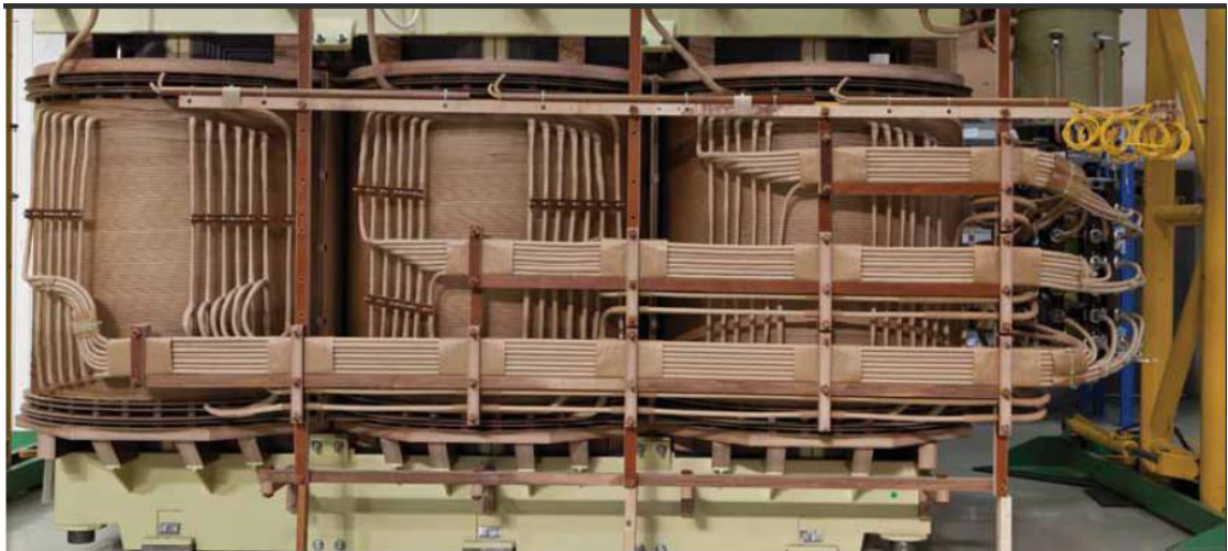
Figura 50. Parte viva de la máquina estudiada con todos los elementos necesarios para su operación. De los diseños CAD bidimensionales de esta máquina se extrajo la información para los modelos CAD tridimensionales utilizados en los estudios que este documento muestra.
